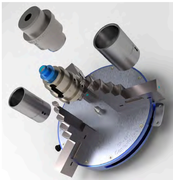
CenterFIX-Werkstückträger (3-Backen Ausführung, mit ALU-Gehäuse) 2-teilige Stufenbacken (steckbar) mit div. Zusatzadaptern, die in den Backen oder auf dem mittig auf dem Deckel positionierten Rastzapfen adaptiert werden können. Die Zusatzadapter dienen z.B. der Aufnahme von wellenförmigen Werkstücken, die nicht mit den Stufenbacken aufgenommen werden können.
