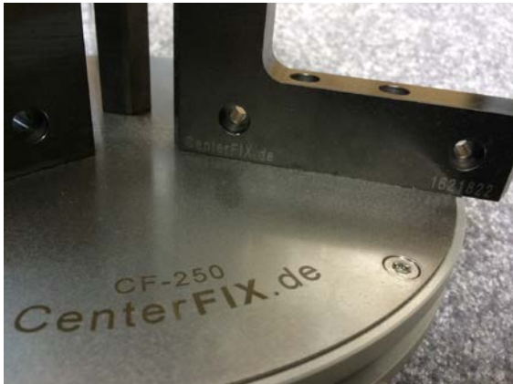
Abb. oben: CenterFIX-Schriftzug mit System-Nenngröße auf Systemdeckel und kundeneigene Werkzeugnummer auf Sonderbacke.
