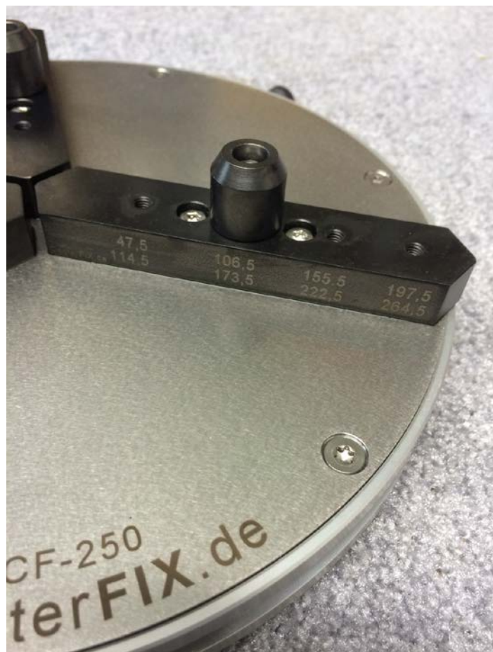
Abb. oben: Beschriftung unterschiedlicher Zentrierbereiche an den verschiedenen Gewindebohrungen der Sonderbacke.
