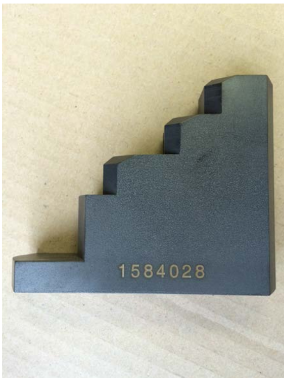
Abb. unten: Beschriftung einer kundeneigenen Werkzeugnummer auf Sonder-Stufenbacke
