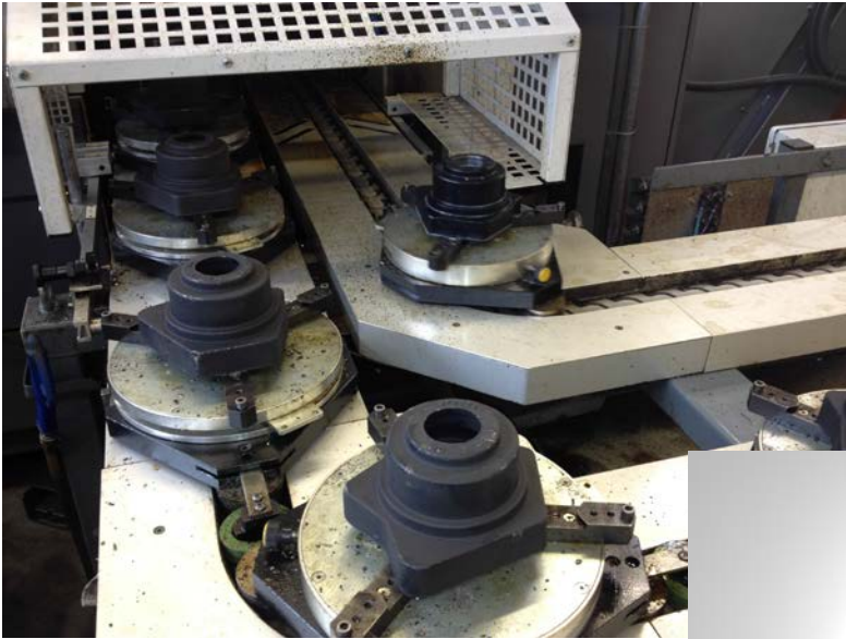
Abb. oben links: EWAB-Transportsystem mit CenterFIX-250 an OKUMA LVT300
