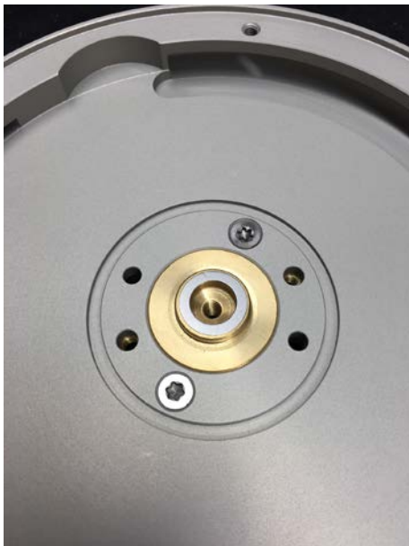
Abb. oben links Passscheibe/n auf der Zentrierscheibe beeinflussen die Selbsthemmung des Systems. Sprich: wie leicht bzw. schwer sich das System über den Bedienehebel öffnen / schliessen lässt.
