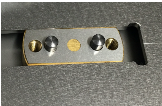
Abb. unten links Passscheibe/n auf dem Gleitstein beeinflussen das Spaltmaß zwischen Backe / Segment und Systemdeckel und damit ein mögliches Abkippen hoher / langer Werkstücke (z.B. Wellen oder Werkstückstapel)
