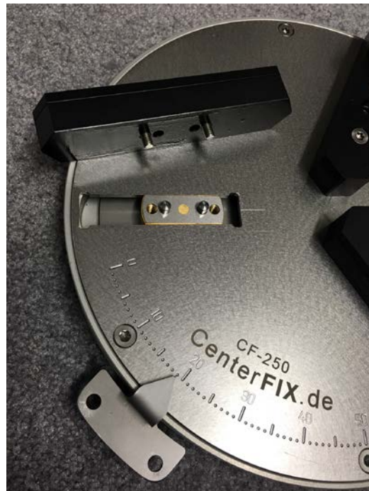
Abb. unten rechts Durch Beilage der Passscheiben (0,01 / 0,025 / 0,05 / 0,10) kann das Spaltmaß auf ein Minimum reduziert werden. Ohne Passscheibe lassen sich Backe / Segment fest auf den Systemdeckel klemmen.
