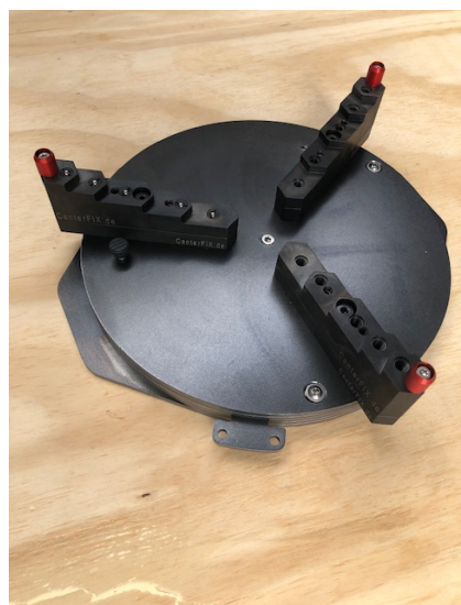
Bild rechts: Lange Werkstückauflagen / Backen, die den Führungsschlitz im Systemdeckel in jeder Position vollständig abdecken. Bei dieser Variante können weder seitlich noch von oben Späne / Fremdkörper eindringen.
