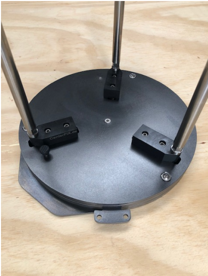
Bild links: CenterFIX-ECO mit kurzen Werkstückauflagen / Backen und Führungsstangen für Stapelanwendungen.
