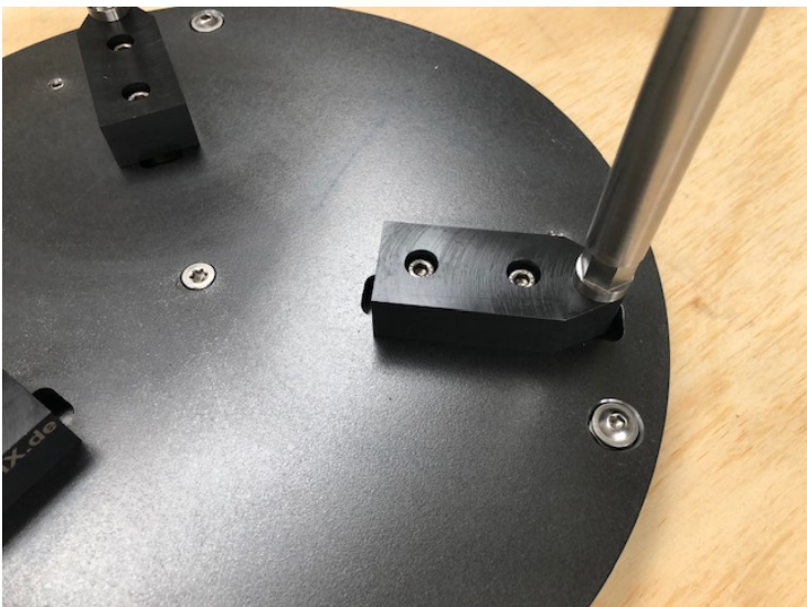
Bild links: Kurze Werkstückauflagen / Backen, bei denen sich der Führungsschlitz im Systemdeckel öffnet, so dass sich diese Ausführung bei Anwendungen mit hoher Spänebelastung nur bedingt empfiehlt. Allerdings lässt sich das System mit wenigen Handgriffen komplett zerlegen, reinigen und wieder komplettieren. Da man bei dieser Ausführung jedoch einen deutlich größeren Systemhub realisieren kann, muss man hier ggf. den praktischen Nutzen und gelegentlichen Reinigungsaufwand gegenüberstellen. (Hinweis: bei vergrößertem Systemhub, ist der Führungsschlitz im Systemdeckel deutlich länger)
